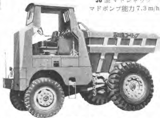
60WS ダンプター 積載重量 7.5 吨
