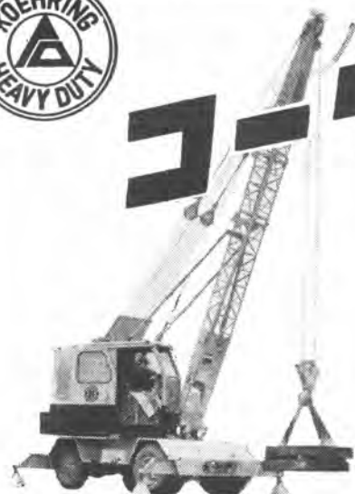
205型 クルーザークレーン 吊上重量 12.7吨 走行速度 10.7 km/h
