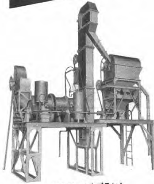
アスファルトプラント
