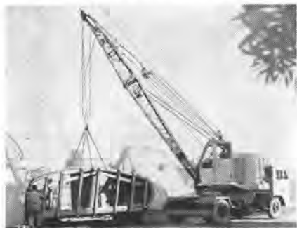
写真-1 日立 F03 トラッククレーン
