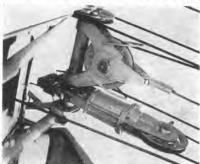
写真-3 F03 トラッククレーンの転倒防止装置
