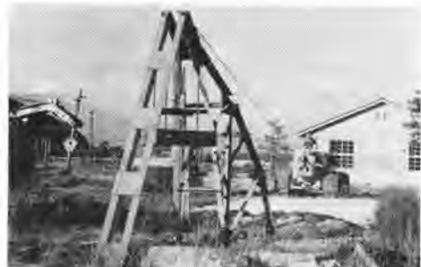
写真-2 トラクタのウインチ試験
