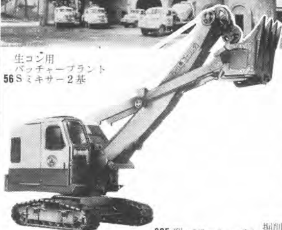
305型 パワーショベル 掘削容量 0.6 m 3 吊上重量 13.6 吨
