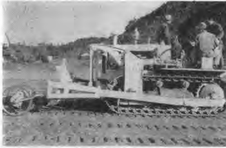
写真-3 トラクタ（ドーザ付）の走行試験
