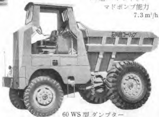
60WS型ダンプター 積載重量 7.5 吨 廻転座席型
