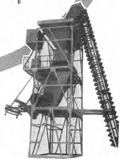
バッチャープラント
