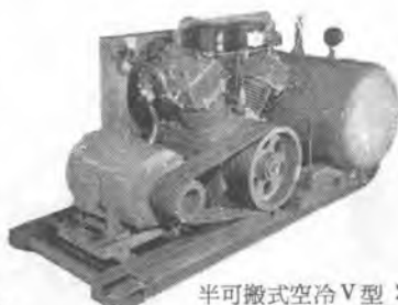
半可搬式空冷V型 22 kW (モーター駆動)
