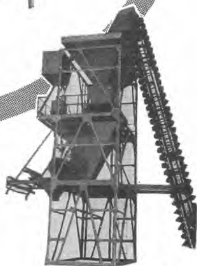
バッチャープラント
