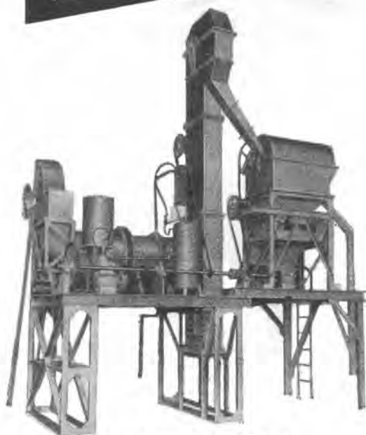
アスファルトプラント
