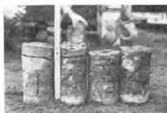
写真-3 コア採取状況 コア上部亀裂部上層が注入マッドの固まったもの
