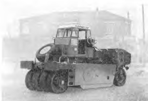
写真-51 フランス——アルバレー会社の自走式タイヤローラ“イソパクタ”…各タイヤが独立に動く。
