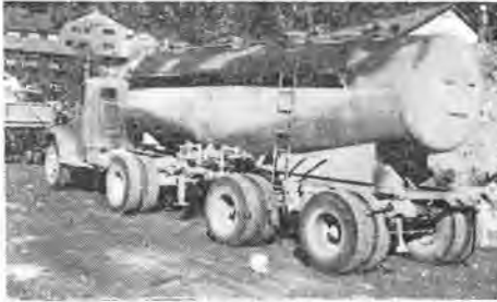
写真-6 バラセメント輸送用トレーラ (20t積)
