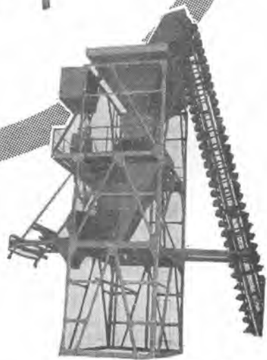
バッチャープラント
