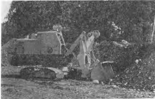
写真—15 ミルウオーキー——コーリング社製スクーパ が同社ブルーピンググラウンドで試験されてい る。
