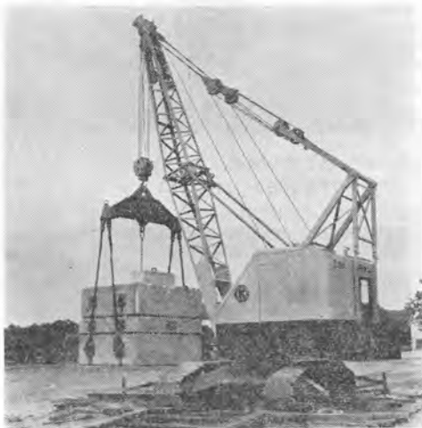
写真—26 ミルウオーキー——コーリング社製トラクタ クレーン(米海軍発注)を同社のブルーピング グラウンドで荷重テストを行っているところ, トラックフレームにアウトリガーがついてい る。(つり上能力 30 t)
