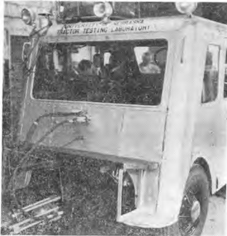
写真—18 ネブラスカ大学——トラクタテスト用計測車。けん引かん部分の油圧シリンダに注意。
