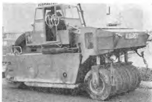
写真-52 “イソパクタ” の前輪…タイヤはそれぞれ独立に油圧により支えられている。
