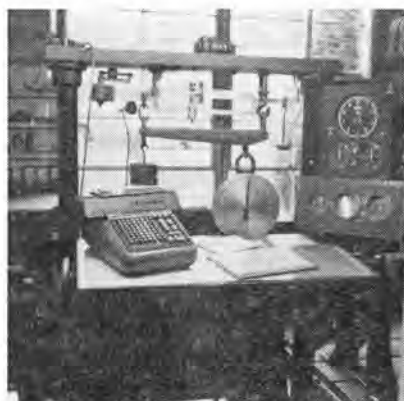
写真-5 P.T.O. Horsepower の計測装置
