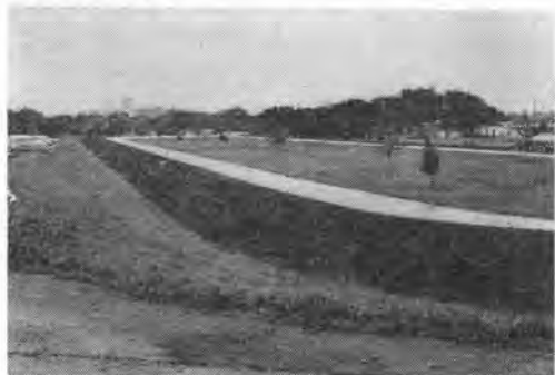
写真-8 Drawbar Testing Field 内側がコンクリート舗装道、外側が土道で他は芝生
