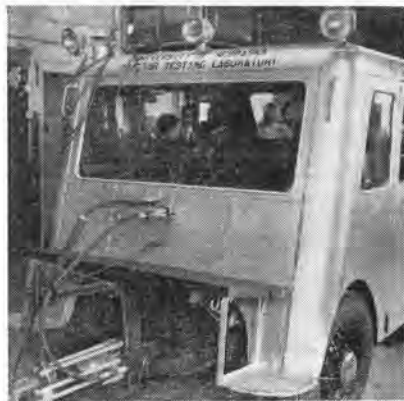
写真-6 Drawbar performance Test 用計測車 前面下方にあるのは油圧式の Pull meter. 油圧は計測車の中に導かれて Selfrecorder に配管されている。計測車にはこのほかに試験車の Engine 回転、油圧車、車輪回転等を測定するための配線がしてある。
