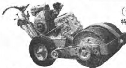
1R-II 型(自重 580 kg) 輾圧力 1 TS~10 TS
