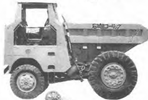
60WS型 ダンプター 積載重量 7.5 吨 回転座席附
