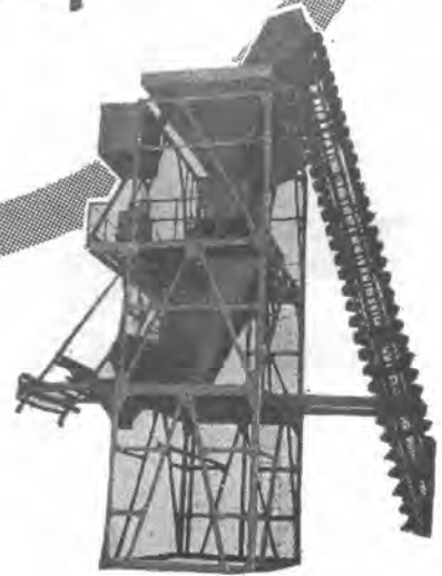
バッチャープラント
