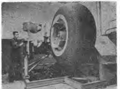
写真-3 タイヤを正しい寸法輪郭にパフ仕上げる。
