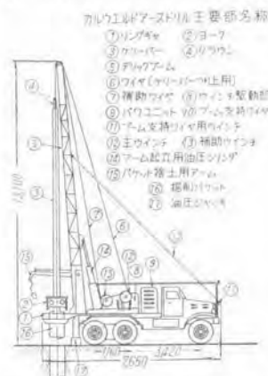
図-1 カルウェルド150A形概要図
