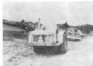
写真-4 方向変換を終えたモータスクレーバ、後にプッシャが後押しの態勢にある。
