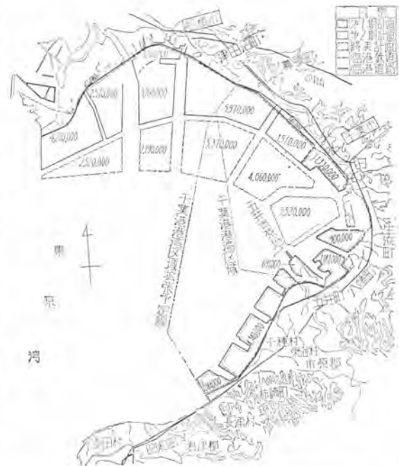
図-4 千葉港、五井、市原地帯整備および東京湾北部埋立計画平面図(注、数字の単位は坪)
