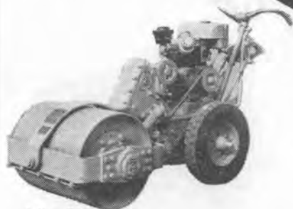
IR-II型 自重 580kg 輾圧力 1TS~10TS
