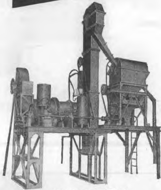
アスファルトプラント
