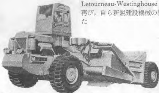
L-28 型能力平積20.5 立方ヤード 420 馬力ディーゼル発電機搭載
