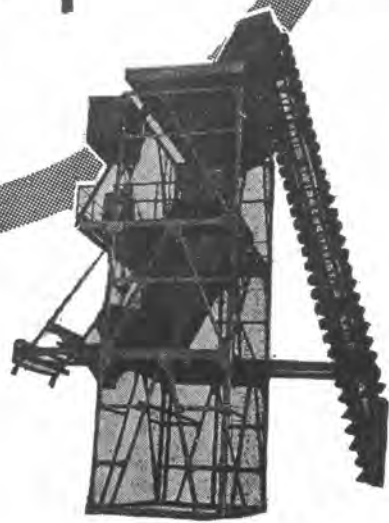
バッチャープラント
