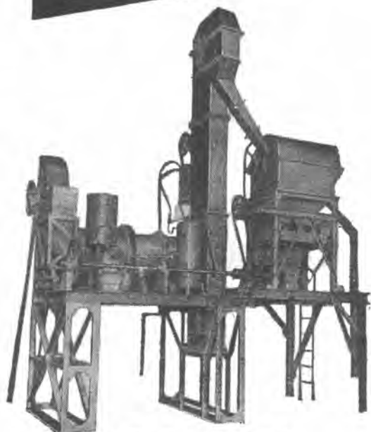
アスファルトプラント
