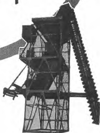
バッチャープラント
