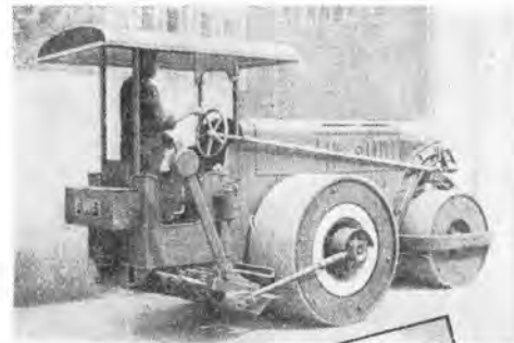
図-7 アルバレ社の空気タイヤ入りロードローラ
