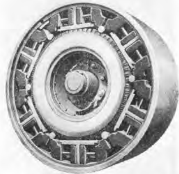
図-8 空気タイヤ入り車輪の構造
