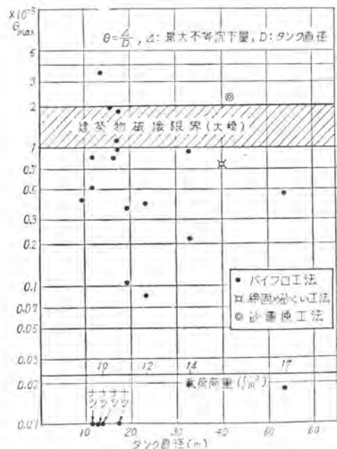
図-2 オイルタンクの不等沈下角
