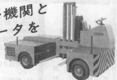
Z 312型機関及びSCA 0.85型 トルクコンバータ搭載の5トン サイドホークリフト
