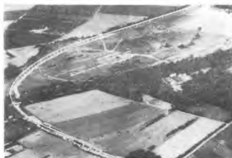
写真2 Cologne 郊外 Euehlingen ALWEG 試験線全景 (1,957年建設) 中央部の楕円形白線は1,952年に建設された1/2.5サイズのモデル試験線である。
