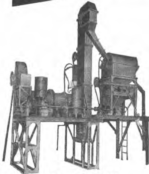
アスファルトプラント
