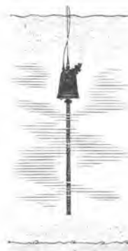
図-3 港湾の凍結防止のために海水の循環に使用している
