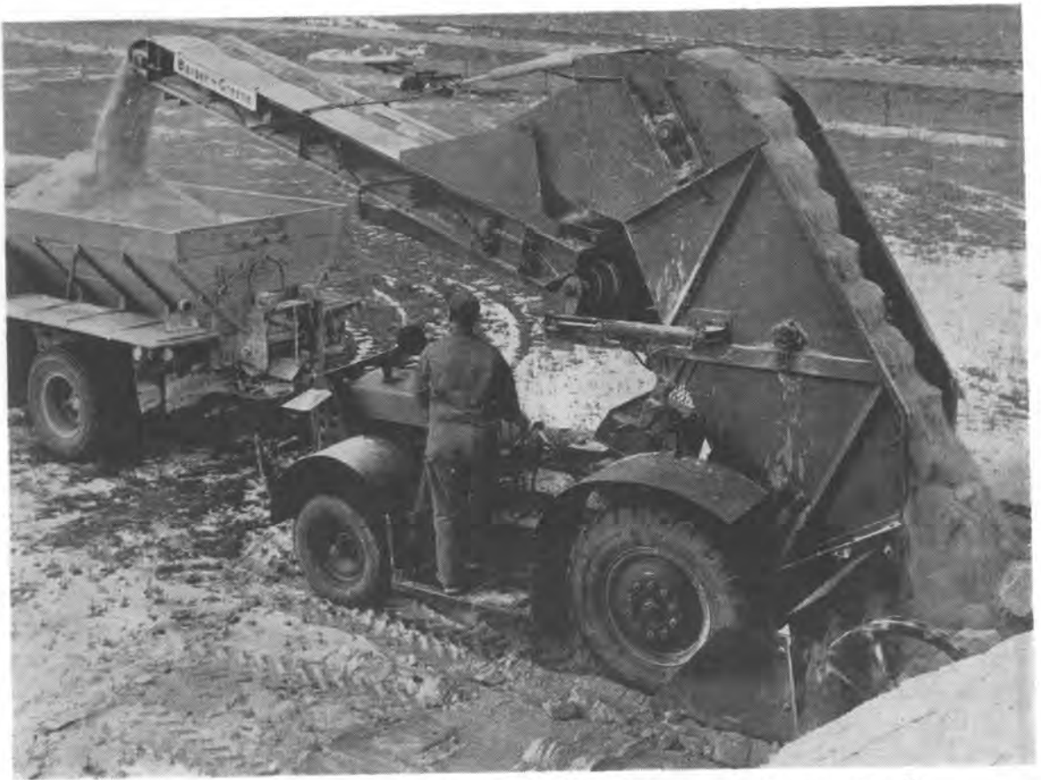
アイオワ州セントアンズガーにあるフォーク建設会社が使用中のバーバー・グリーン・ローダー
