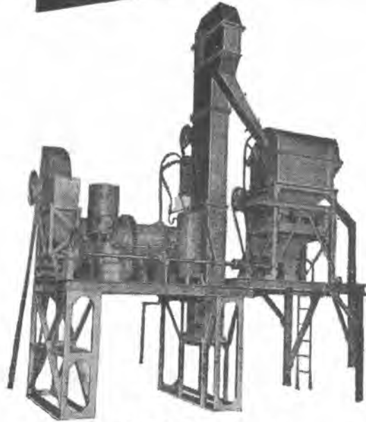
アスファルトプラント
