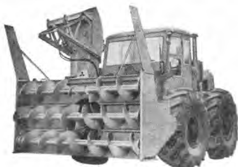
写真-2 ロータリ除雪車
