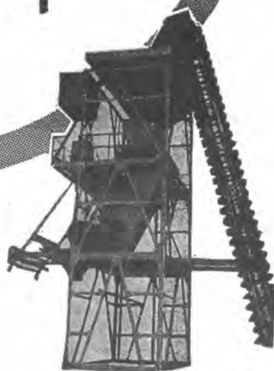
バッチャープラント
