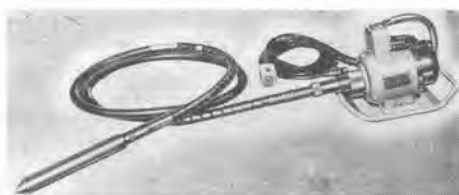
写真-1 現在のフレキシブル式内部振動機
