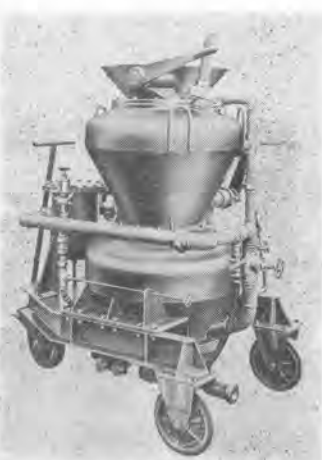
写真-1 B.S.M. 社の 630 型コンクリート吹付機
