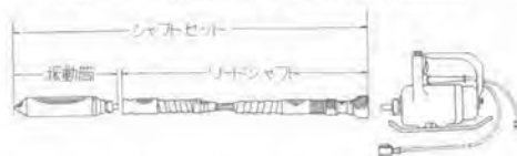
図-1 現在のフレキシブル式内部振動機分解図
