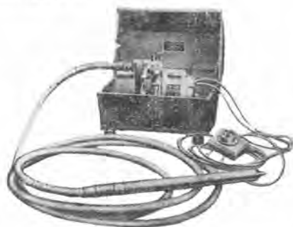
写真-2 戦前のフレキシブル式内部振動機
