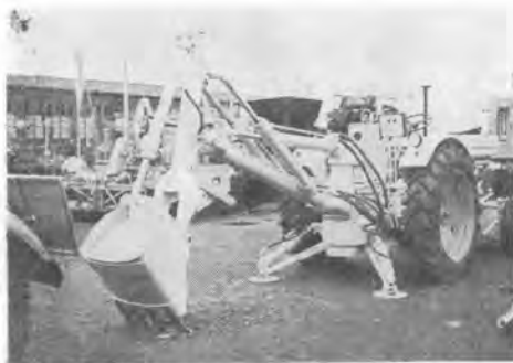
写真—8 トラクタ搭載の油圧バックホウ
