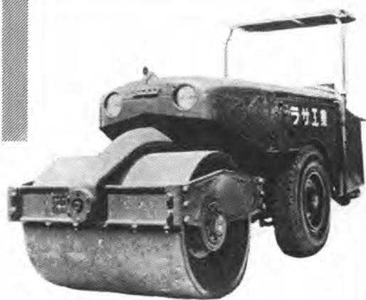
1R-5型 自重2000kg 輾圧力 最大18TON 可変式
