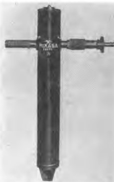
写真-5 エアモータ直結式内部振動機
