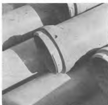
(特許) トレミー管接手構造
