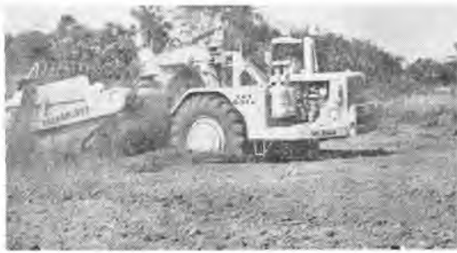
写真-2 習志野における No. 631 の走行 盛土地区を走行しているためタイヤがもぐる
