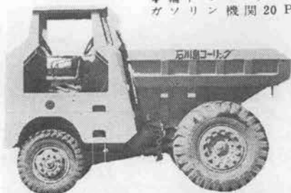
60 WS形 ダンプター (回転座席式) 積載量 7.5吨 (4.8m 3 ) 走行最高速度26.6km/h ディーゼル機関109P S
