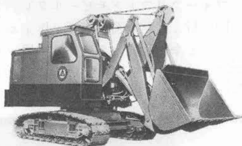
205形 スターバー (全旋回式積込機) バケット容量 1.6m 3 (一般用) 押出能力10,900kgディーゼル機関75P S オイルラム駆動式クローラーを駆動することなく掘込、旋回、投棄が同時に出来る
