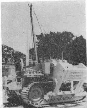
写真-15 サイドクレーン付ブルドーザ (アリスチャルマ社製)
