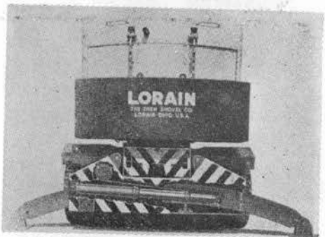
写真-17 Lorain MC 325, 22.5t トラッククレーンの油圧アウトリガ
