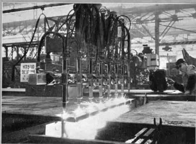
← 量産に活躍する鋼板の連続ガス切断機。
