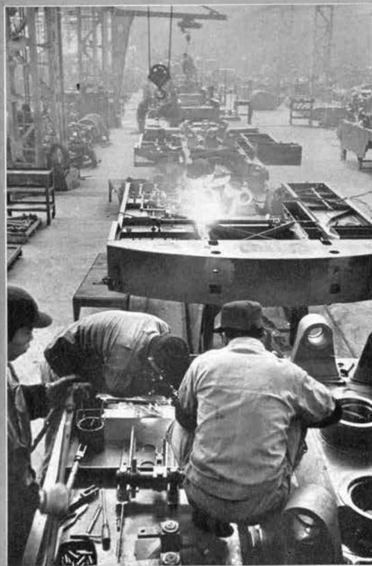
↑続々組立工場に送り込まれるショベル用施回主フレーム。
