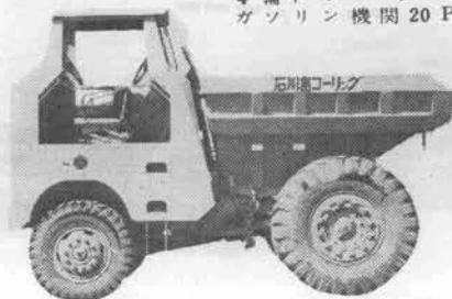
60 WS形 デンブター (回転座席式) 積載量 7.5吨 (4.8m 3 ) 走行最高速度26.6km/h ディーゼル機関109P S
