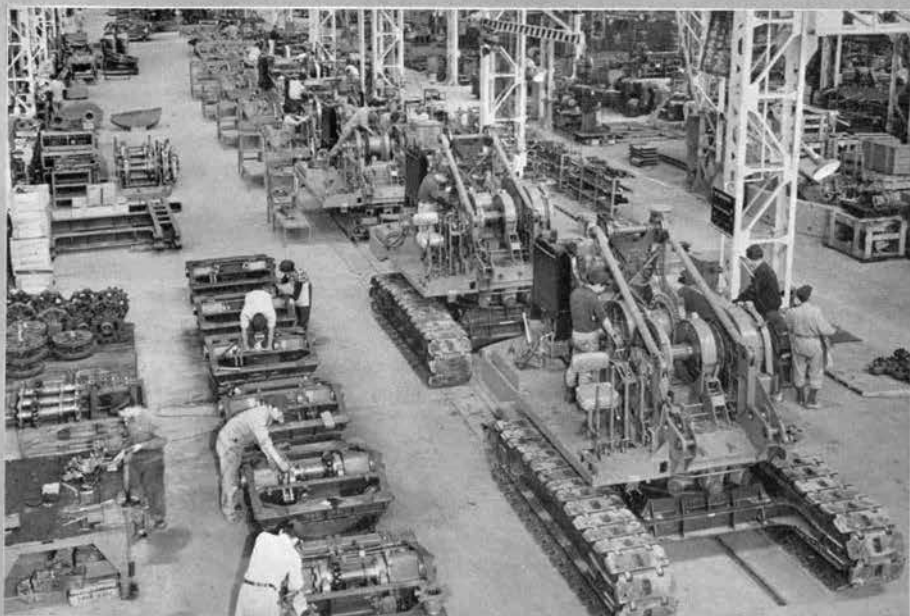
↑組立工場でタクト式流れ作業により日夜量産されるU106 万能掘削機。
