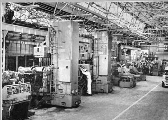
↑エンジン工場 専用機によるクランクケース加工ライン
