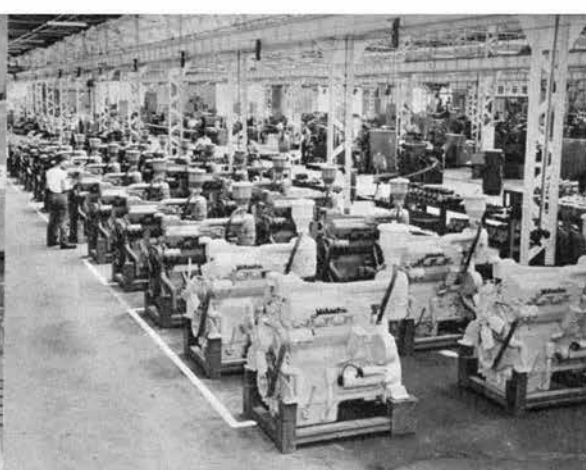
↑テストを終えて勢ぞろいしたエンジンは組立工場に送られるまで待機。
