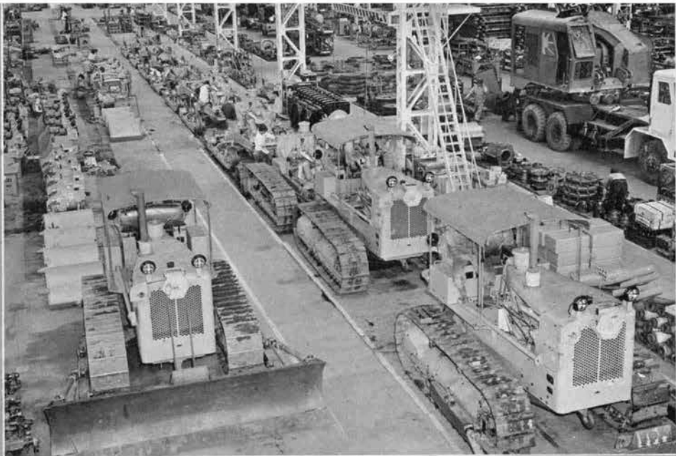
↑流れ作業に乗り生産されるT09 ブルドーザ。
