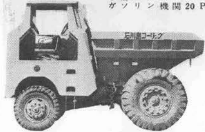
60 WS形 ダンプター (回転座席式) 積載量 7.5吨 (4.8m 3 ) 走行最高速度26.6km/h ディーゼル機関109 P S
