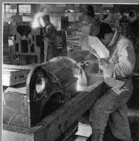
↑ミッションケースの溶接も量産の一翼を担っている。
