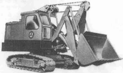
205形 スクーパー (全旋回式積込機) バケツ容量 1.6m 3 (一般用) 押出能力10,900kg ディーゼル機関75 P S オイルラム駆動式クローラーを駆動することなく揚込、旋回、投棄が同時に出る
