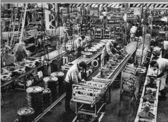
↑エンジンのサブアッセンブリーライン。 こゝで組立てられた部品は、隣のエンジン組 立ラインに流される。
