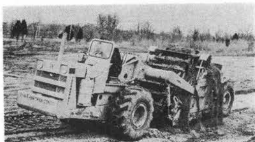
写真-6 ハンコック・エレベーターングスクレーパー(ルターナ社)
