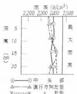
図-6 差込バイブレータ スランプ 4±0.5 cm
