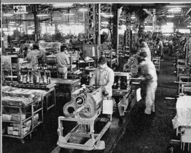
↑サブアッセンブリーラインから流されてきた 部品は、エンジン最終組立ラインで手ざわよ く組込まれ、エンジンが組立てられてゆく。
