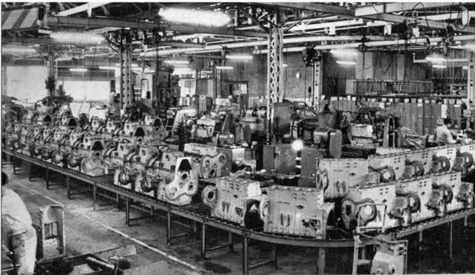
← 各種加工専用機 を経て続々と流 れてゆくクラン クケース群。
