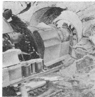
写真-6 圧縮強度 1,450 kg/cm 2 のライム石の切削
