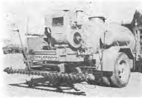
写真-18 米国リットルフォード社 101 型 アスファルトデストリビュータ
