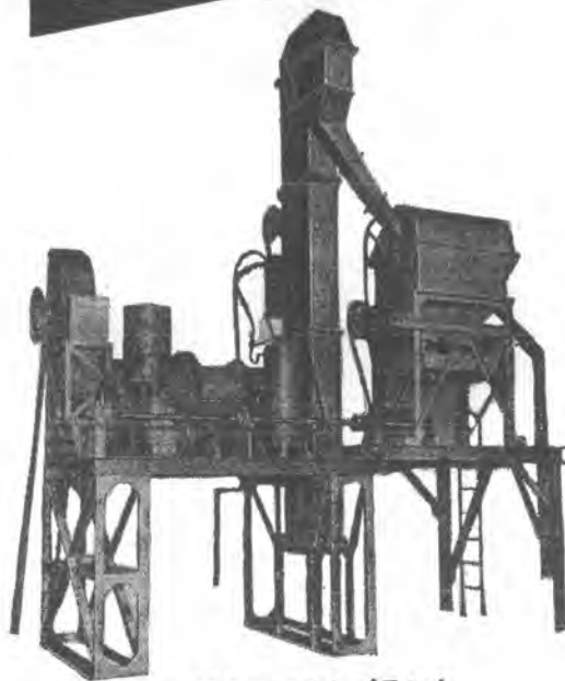
アスファルトプラント
