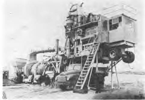
写真-1 パーカー社スタミックス 37 型 アスファルトプラント
