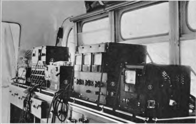
↑ ホリゾンタルオーガの性能試験時に使用 した計測車内の測定器 右から ① 歪計アンプ (小) ② 歪計アンプ (大) ③ ペン書きオシロ ④ 6要素オシロ ⑤ 歪計電源
