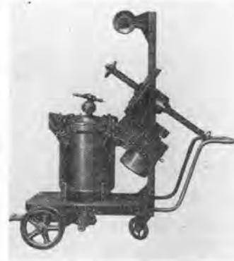
写真-2 エアモルタル用グラウトミキサ
