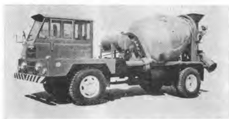
写真-1 ドラム回転形コンクリートアジテータトラック (犬塚製)
