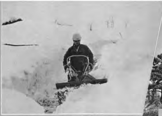
↑ 小型除雪機械の性能試験 — 除雪限界野外試験 谷藤機械 “スノーバー” (昭和36年冬)
