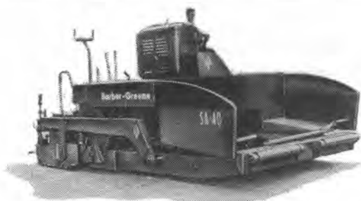
SA-40フィニッシャー 近代的なアスファルト舗装機として改良された最新式の一般作業用機。
