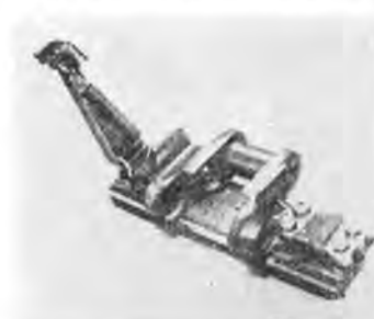
写真-1 歪ゲージを履帯に組込み、回転ケーブルで記録計に接続されている。
