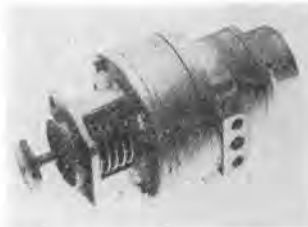
写真-2 ニューマティックブレッシュレショウコントロール装置
