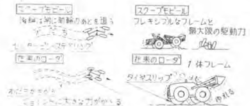
図-1 センターピン・ステアリング
