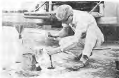
図-5 Sand-Cone による安定処理土の密度試験
