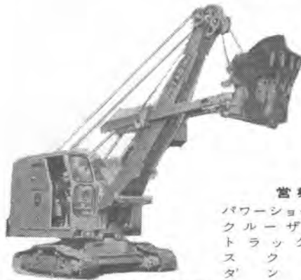
305形 パワーショベルバケツ容量 0.6m 3 ディーゼル機関91P S フロ ントアタッチメントを容易に組替する ことにより、ホ- クレーン・ドラ グライン・クラムシェルに使用出来る
