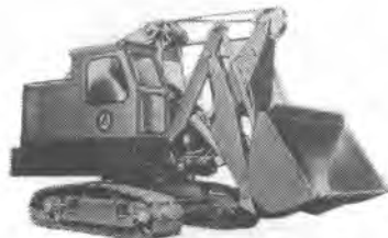
205形 スクーパー (全旋回式積込機) バケツ容量 1.6m 3 (一般用) 押出能力10,900kg ディーゼル機関75P S オイルラム駆動式クローラーを駆動することなく掘込、旋回、投棄が同時に出来る
