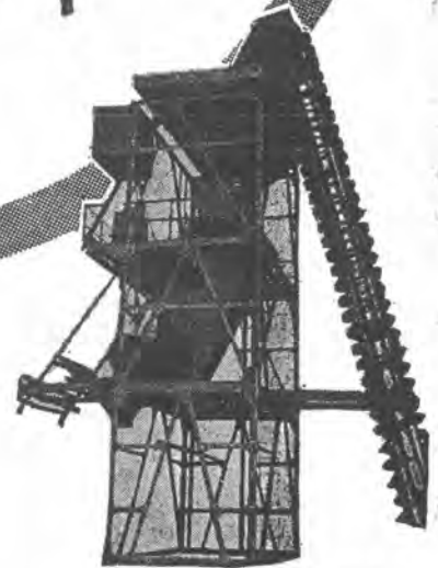
バッチャープラント
