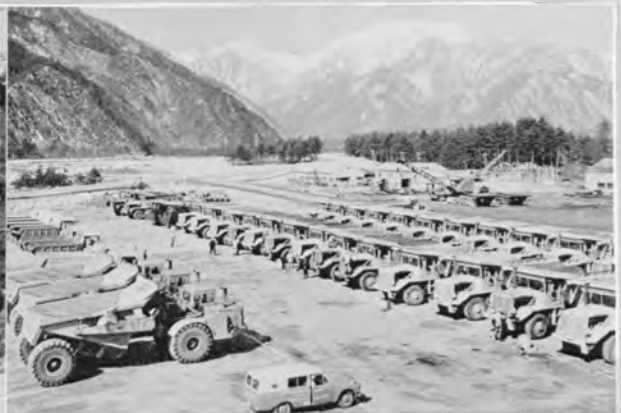
↑長野県大町市の信濃大町駅北方2kmの地点に設置された黒四荷卸用の北大町専用駐車場の広場に勢ぞろいした骨材輸送、ダム掘削すり輸送用の大型ダンプトラック(20t以上の容量)48台の偉容、正面の山は北アルプス。
