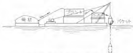
図-15 サンドマチック作業船 (和歌山北港防波堤工事用)
