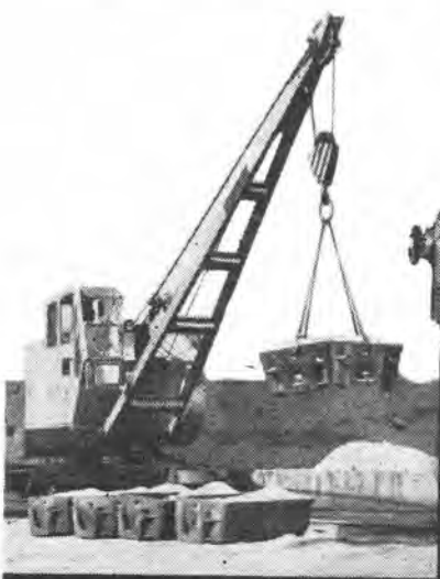
Z312型機関及びSCA0.85型トルクコンバータ搭載の5トントラッククレーン
