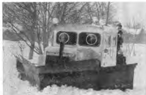
写真-3 モータカーラッセル
