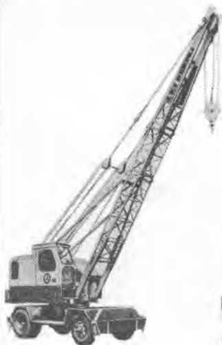
205 CS形 クルザークレーン 吊上能力12.7吨・走行最高速度13km/h ディーゼル機関80PS トルクコンバーター付
