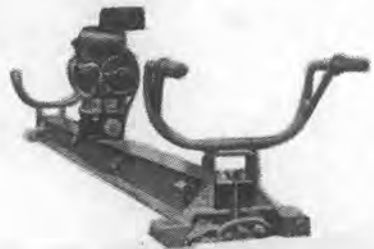
路面仕上機 F型3号
