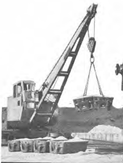
Z 312型機関及び SCA 0.85型 トルクコンバータ搭載の 5 トン トンボクレーン
