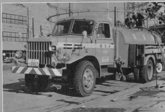
← 区画線塗布作業中の車載式ラインマーカー
