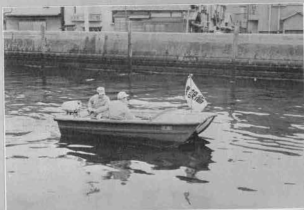
↑陸上のパトロールカーに対して、水上ではパトロールボート（作業船）が、橋りょうの定期点検・調査に活躍する。
