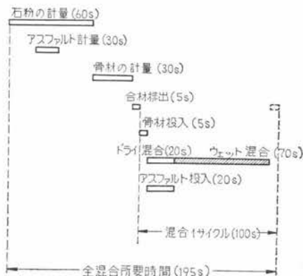
図-4 混合時間および混合のサイクルタイム
