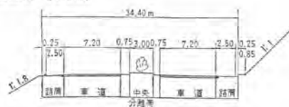
図-3 各国高速道路の幅員構成例 (土木学会編(1960):最近の道路問題と高速道路より)
