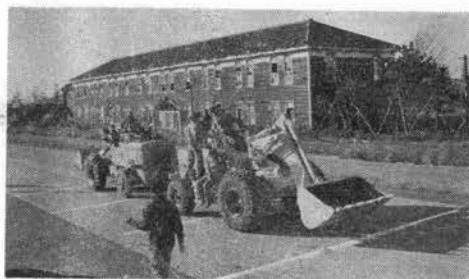
写真-2 スイングショベルローダの走行抵抗試験
