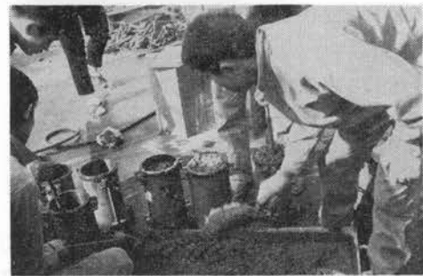
写真-26 圧縮強度試験用供試体の製作状況
