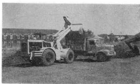
写真-4 スクープモビールの積込作業試験
