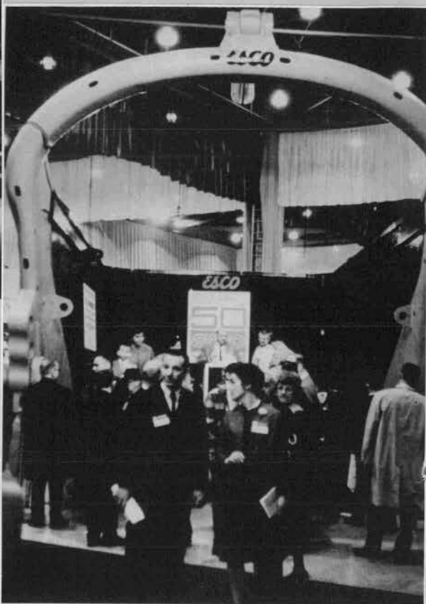
↑巨大なドラグラインバケット (Esco: 85 cu. yd. 自重 94t) アーチ部の高さは5 mもある。
