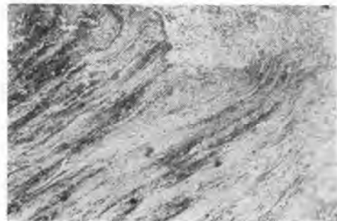
写真-3 金属組織の流動を起した車輪断面
