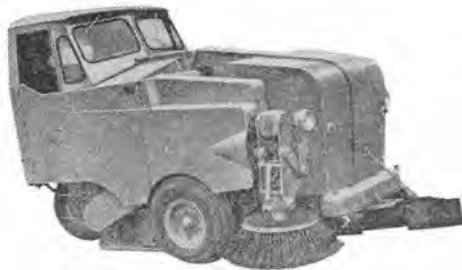
写真-1 SW-H 形路面清掃車
