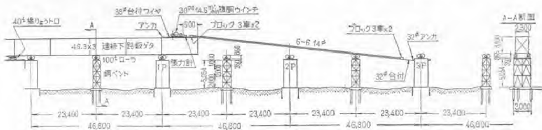
図-7 連続桁の引出し(安倍川橋りょう)
