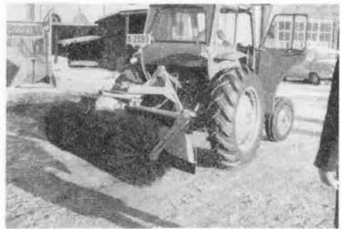
写真-8 前部に積込用バケット、後部に掃除用ブラシのついた車（オスロ市）
