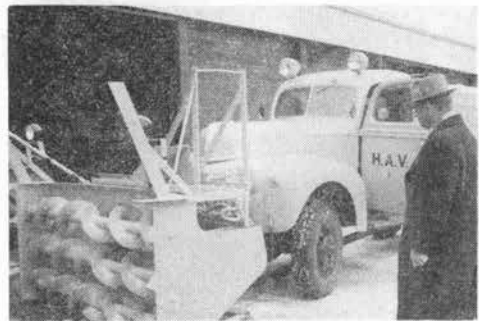
写真-9 ロータリ除雪車
