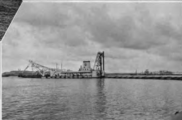
↑4,000PSタービン駆動ポンプ浚渫船“大平丸”
