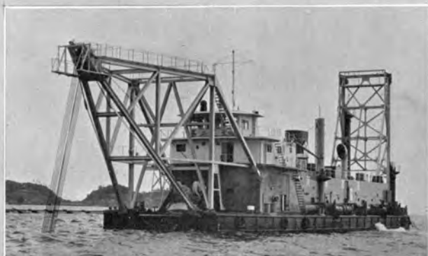
↑4,000PSタービン駆動ポンプ浚渫船“大平丸”
