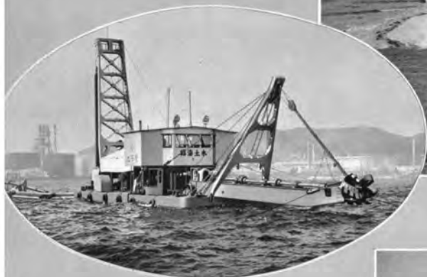
↑ 岩国の臨海工業地帯埋立工事中の260kW陸搬式電動ポンプ浚渫船“龍田丸”
