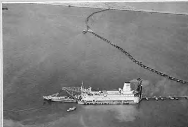
↑堺港で埋立工事に活躍する11,500kWターボエレクトリックポンプ浚渫船“国栄丸” ポンプ電動機は8,000PSである。
