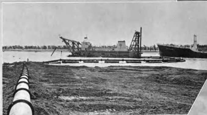
↑スエズ運河の拡幅、増深に活躍する5,000PSタービン駆動ポンプ浚渫船“SUEZ”
