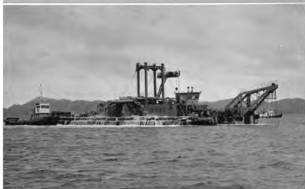
↑ 土運船に積込中の1,000PSカッターレスポンプ浚渫船“高砂丸” 揚土量約 1,800m 3 /h
