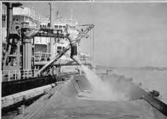
↑ 土運船に積込中の1,000PSカッターレスポンプ浚渫船“高砂丸” 揚土量約 1,800m 3 /h
