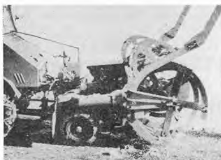
図-54 カッタ型除雪機械
