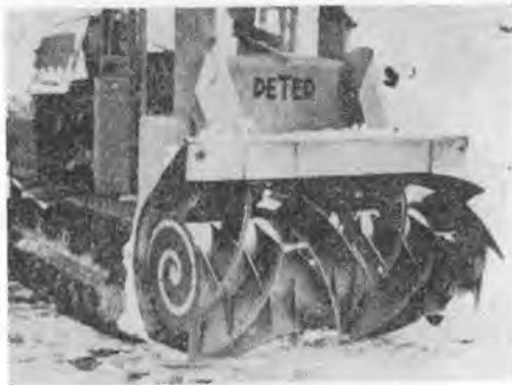
図-41 履帯式ディーゼルハイドロリックピータ型除雪機械
