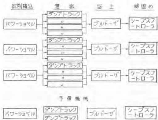
図-21 数系列作業の列(土運搬盛土工)
