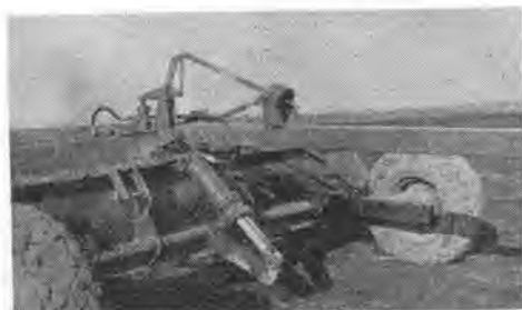
写真-3 アクチュエータと油圧シリンダ
