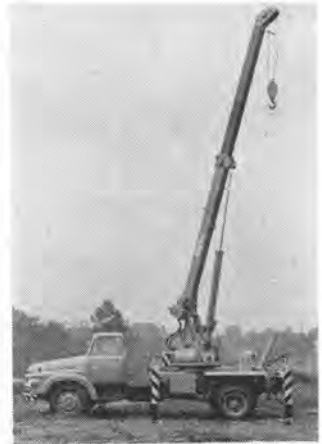
写真-2 CC 50 形油圧式クレーン車
