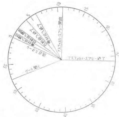
図-2 ミキサタイミングデバイスの60secセットの混合サイクル図
