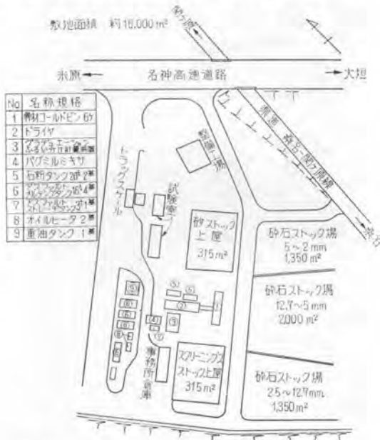
図-1 100 t/hコンテナアスファルトプラント配置図
