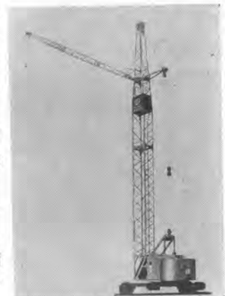
写真-4 三井・リープヘル建築用クレーン 8A型
