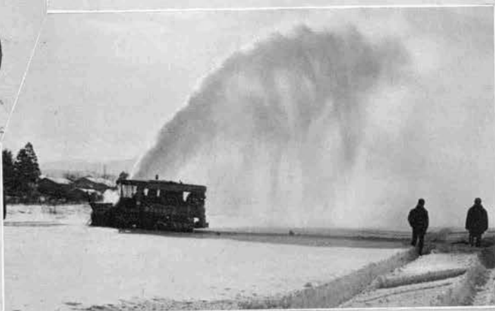
↑ロータリ除雪車：梁瀬 ウニモグ+シュミットWブロウ
