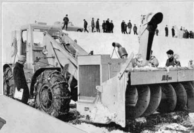
↑ロータリ除雪車：川崎車輛 KLD-5P スノーフライヤ
