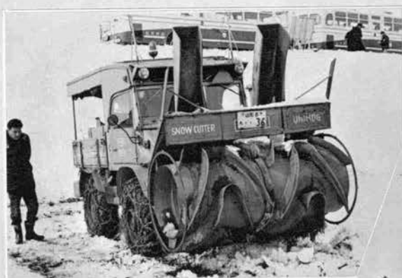
↑ロータリ除雪車：梁瀬 ウニモグ+シュミットカッタ
