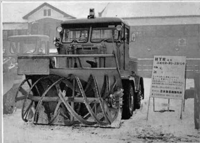
↑ロータリ除雪車：日本除雪機 NTR4
