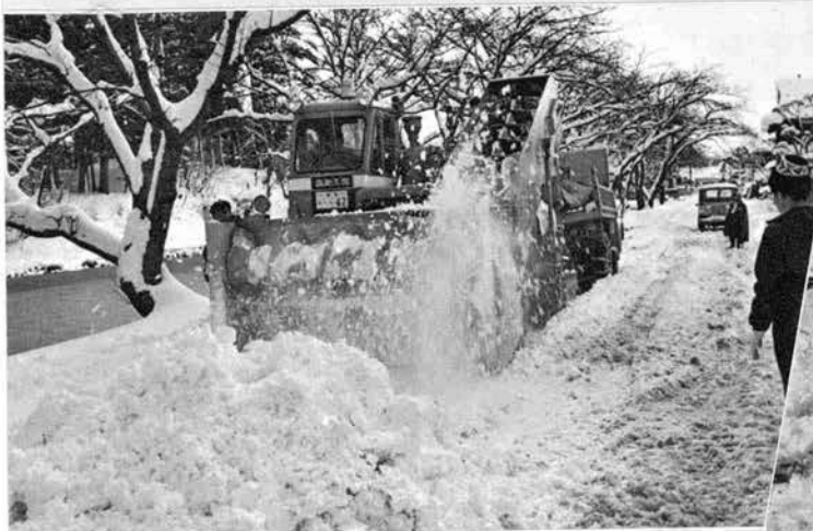
↑スノーローダ：建設省塩釜工作事務所
