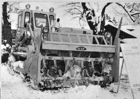
↑ロータリ除雪車：日特重車輛 NTK4 + TBR
