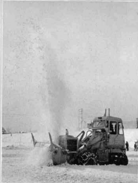
← ロータリ除雪車：東洋運搬機 SD25 + TBR
