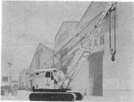
写真-3 335LC クローラクレーン (神鋼 P &amp; H)
