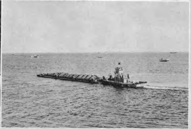
↑土砂を満載して航行中の土運船 普通土運船は2隻横にならべ、後ろから押船で押航するの であるが、この写真では土運船1隻のみ。
