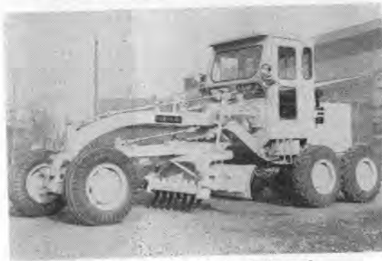
写真-6 HA 46 S モータグレーダ (スカリファイヤ作業時)
