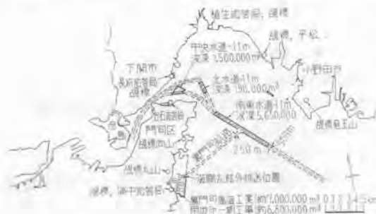
図—1 関門航路浚渫計画平面図(東口)
