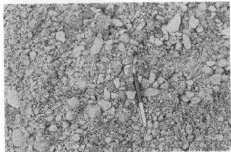
写真-4 アパットメントのバックヒル材料 (Weirs Mill Bridge)
