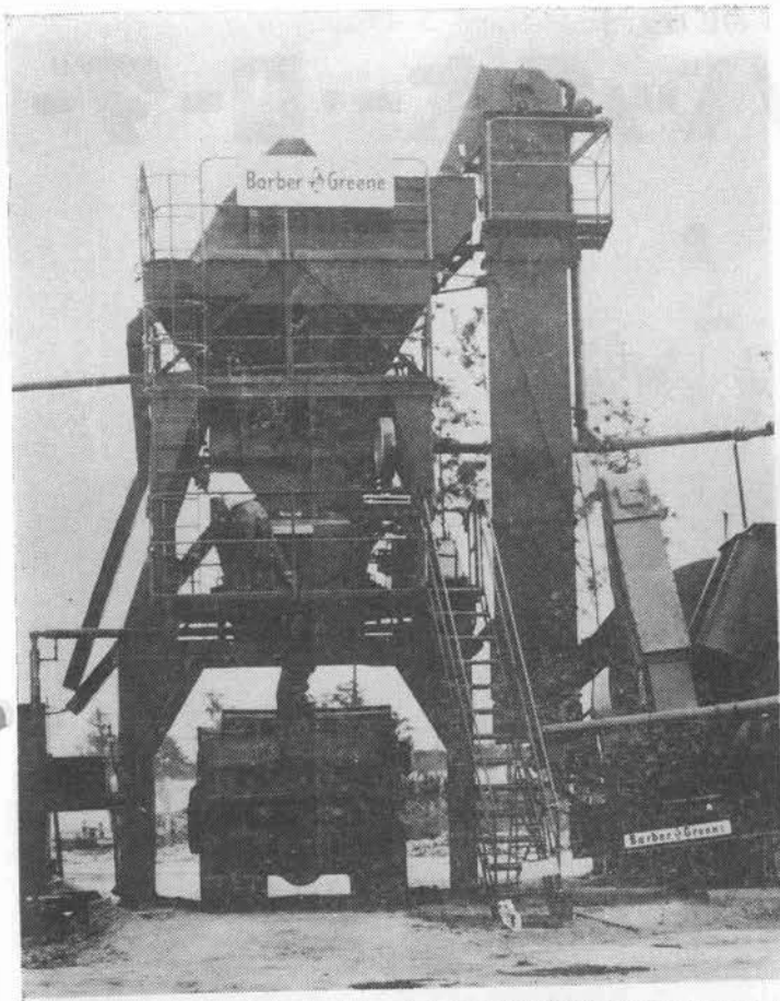
バーバー・グリーンAシリーズバッチプラントは特別な作業に向くサイズ・ドライヤーとコールド・フィード・システムをもっています。バーバー・グリーン社では附属品一切を準備しております。
