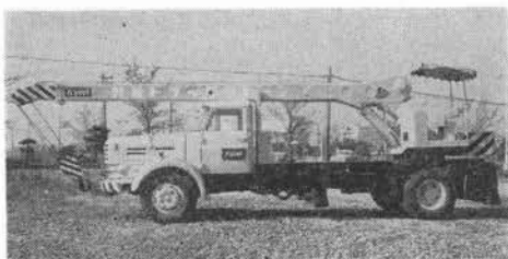
写真-5 共栄 K70 トラッククレーンの走行態勢
