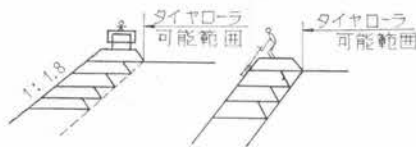
図-13 インパクトローラとビブロランマによる転圧図
