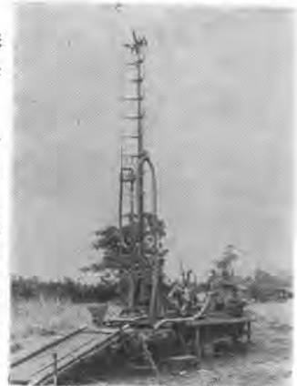
写真-2 RT 6010 形試錐機 (石油さく井機)
