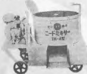
TK-4型(空冷3~4.5馬力エンジン搭載)
