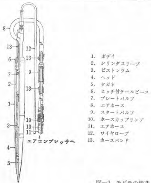
図-2 モグラの構造
