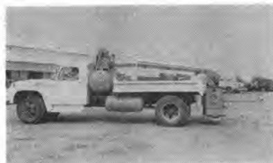
写真-3 エシック道路補修用作業車
