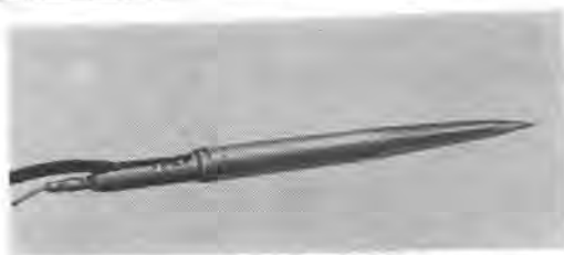
写真-9 地中横孔急速せん孔機「モグラ」(利根ボーリング)
