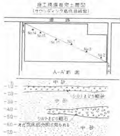
図-4 ある建築の地層断面図
