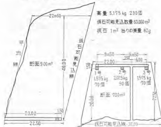
図-7 第5号坑道発破図(鶴田石材(株)菅島工場)
