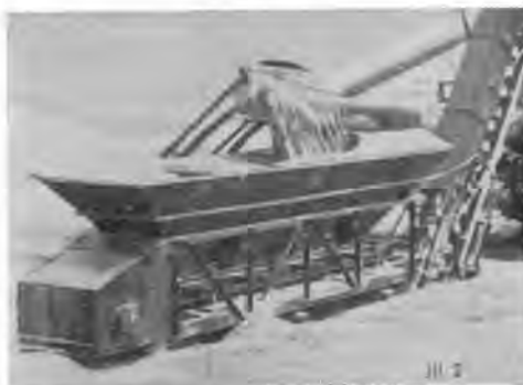
写真-4 コールドフィーダの一例
