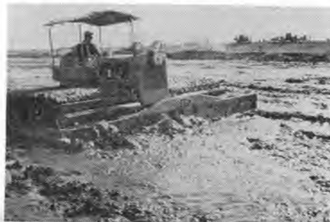
写真-9 NTK-4 超湿地ブルドーザ
