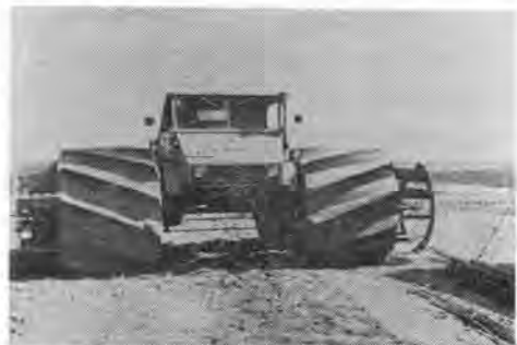
写真-2 ウニモク改造泥上車
