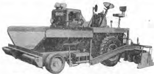
写真-12 三菱 AF-4 アスファルトフィニッシャ
