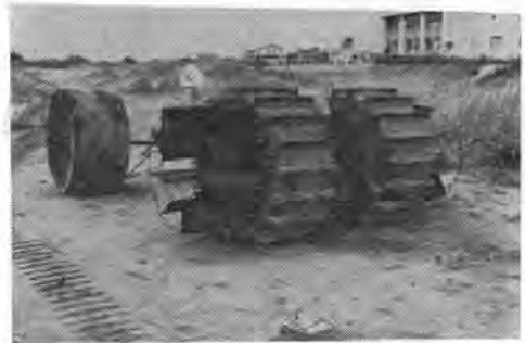
写真-1 耕耘機改造の水陸両用車
