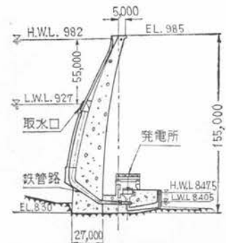
図-4 奈川渡ダムの標準断面図
