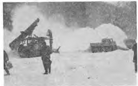
写真-3 大型ロータリ除雪機の実演
