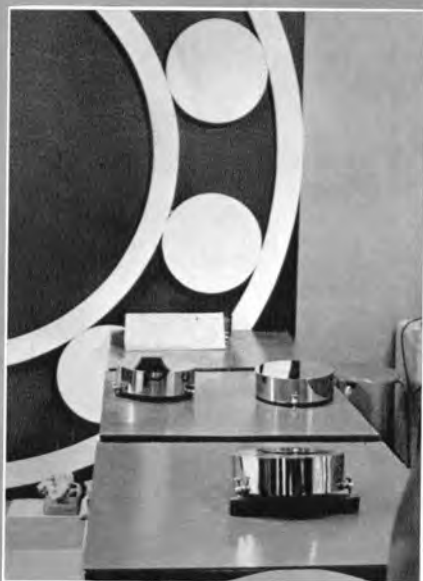
↑ボールベアリング用鋼球の選別検査装置 台の後方から上向きに射出された鋼球 は3個の円形定盤の上を次々に飛びはね て良品回収孔に正確にとび込む。
