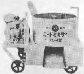
TK-4型(空冷3~4.5馬力エンジン搭載)
