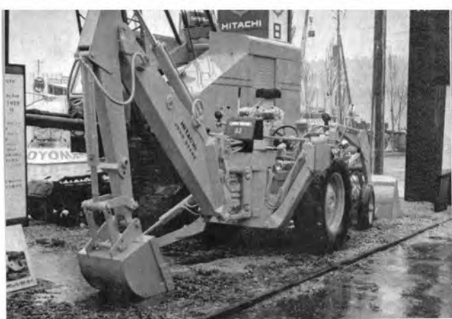
技術提携によるホイールタイプのトラクタシヨベル付バックホウ（日立-ジョンディア）
