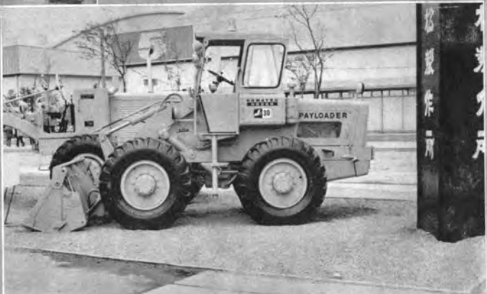
↑ 技術提携のクラムバケット付ホイールローダ（小松-ハフ・ペイローダ）
