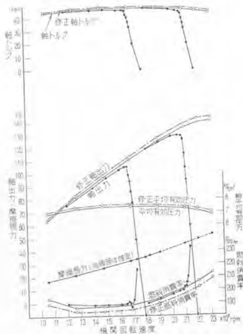
図-18-1 三井・ドイツ BA 6 L 514 型機関性能曲線図
