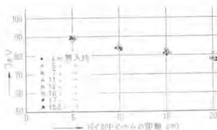
図-6 (a) 浦賀重工製パイプロの場合の騒音
