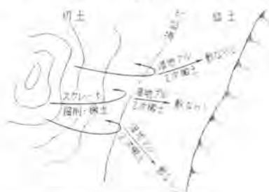
図-8 路体盛土の掘削・搬土
