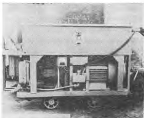
写真-5 9 ft 直径トンネル掘削機用遠隔操作式油圧動力発生装置(台車付) 100 馬力電動機および油圧ポンプ
