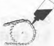
焼付、(1000°C)錆付防止に アンチシーズコンパウンド
