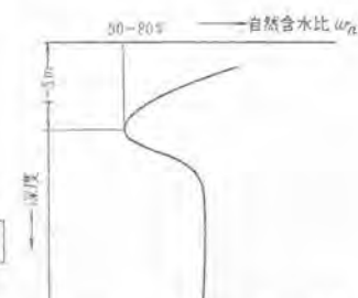
図-6 ボーリング調査における地山の w_n 分布状況
